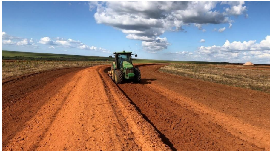
Figura 11 - Trator com grade cortando terraço meia base.
