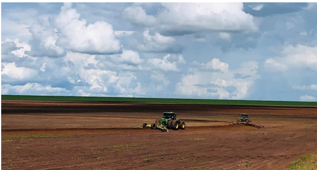
Figura 10 - Trator com terraceador, levantando terraços sistematizados.
